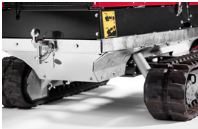
Bodenfreiheit von 200 mm, einfache Wartung und verstärkter Schlauchschutz. Variable Spurbreite von 1.150-1.350 mm
