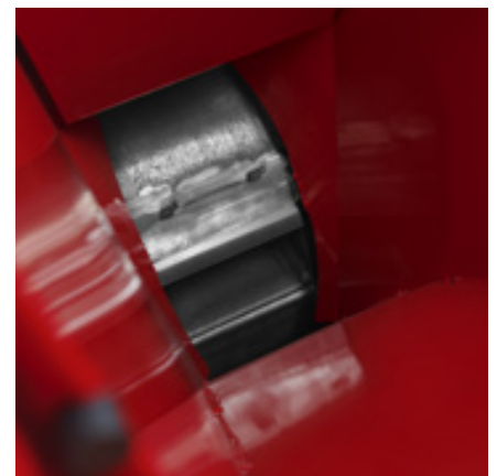
2 wendbare Hackmesser. 1 wendbare Gegenschneide aus verschleißfestem Stahl
