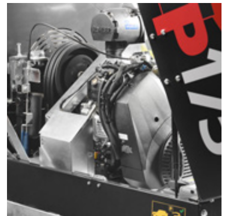
Leistungsstarker Kohler EFI-Motor mit 38 PS
