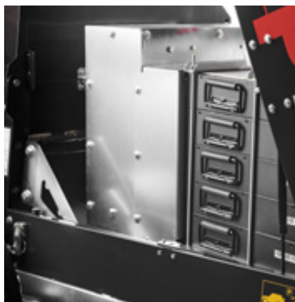
20 kWh (5 Stunden). Lithium-Akku (LiNiMnCoO 2 65V) bietet bis zu 5 Betriebsstunden
