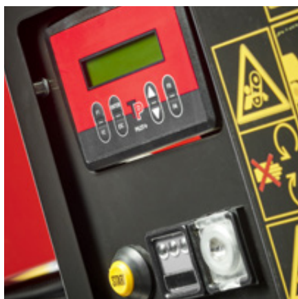
TP PILOT+ med TP Starter. Remmene kobles automatisk til og fra.
