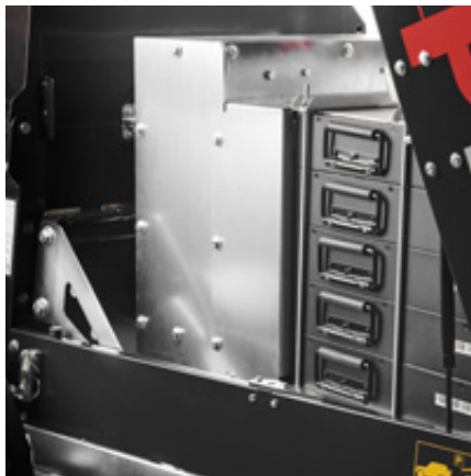
325 ampere (5 timer). Litiumbatterier (LiNiMnCoO 2 65V) gir opptil 5 timers drift.
