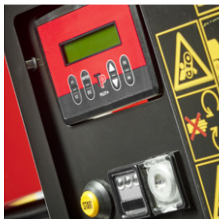
TP PILOT+ med TP STARTER. Til- og frakobling af remme.
