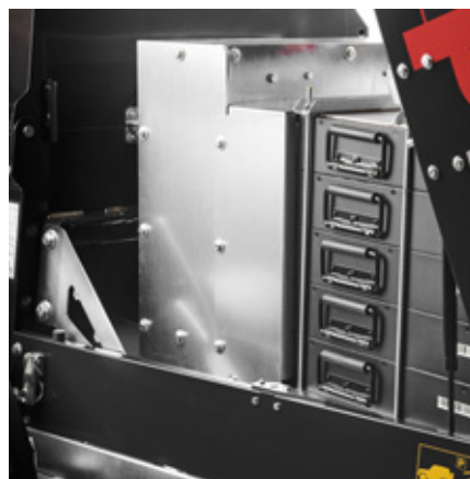
20 kWh (5 timer). Lithium batterier (LiNiMnCoO 2 65V) giver op til 5 timers drift
