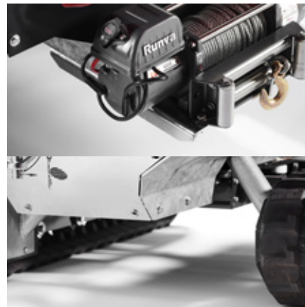
TP Spil kan anvendes, når flishuggeren skal op eller ned af skråninger. Største frihøjde på markedet: 200 mm. Variabel bæltevidde: 1150-1300 mm. Forstærket beskyttelse af hydraulikslanger.
